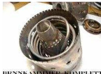
Камера сгорания со змеевиком-испарителем.
