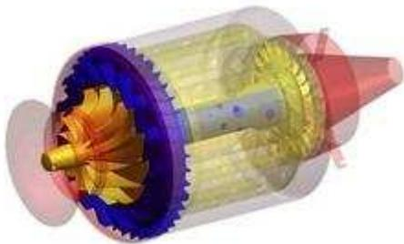
Эскиз турбины под компрессор 66мм.
