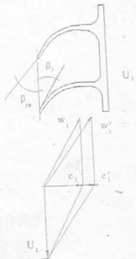
Рис.6. Треугольники скоростей на входе в рабочее колесо компрессора
